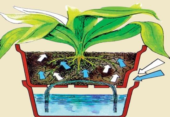
Schematický průřez samozavlažovacím květináčem
