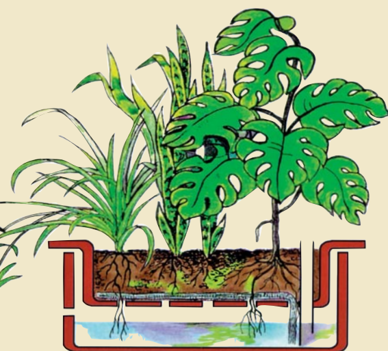
Zdvojení stěn brání přílišnému ohřívání vody na slunci
